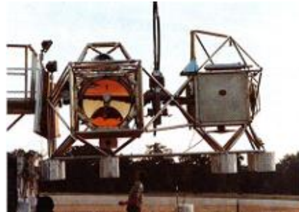
成層圏気球搭載 1m赤外線望遠鏡
